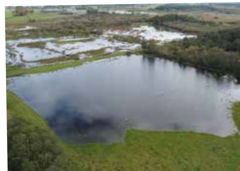
Flera funktioner i en våtmark. Den bortre delen är optimerad för biologisk mångfald och delen närmast kameran för bevattning.
