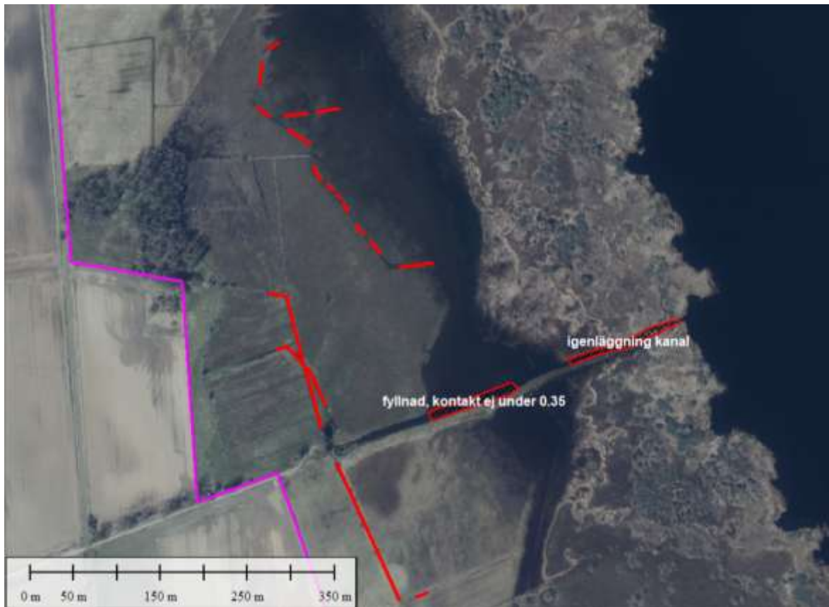
Figur 6: Ett mindre dikessystem norr om fågeltornet, i kanten av den "blå bården" på flygfotot, hindrar naturlig diffus fördelning av ytvatten på strandängen. Dikena kortsluter avrinningen och avvattnar på lägre nivå än naturligt mot den blå bården både i norr och söder. Den blå borden avvattnas i sin tur mot kanalen i söder som är i djup förbindelse med Hammarsjön och även med bevattningspump nära fågeltornet. Anslutningarna både mot Hammarsjön och mot bevattningsuttaget medför en mycket stor begränsning av potentialen för strandängsvadare, andra våtmarksfåglar liksom lekande gädda. Direkt NNV om fågeltornet finns en kraftigt utdikad yta där huvuddelen av avvattningen kan hindras enligt rödmarkerade dikesigenläggningar. Här berörs dock sannolikt avvattning av mark utanför reservatet eftersom marken direkt väster om bara ligger drygt 0,5 m högre (ännu lägre i den obrukade delen).
