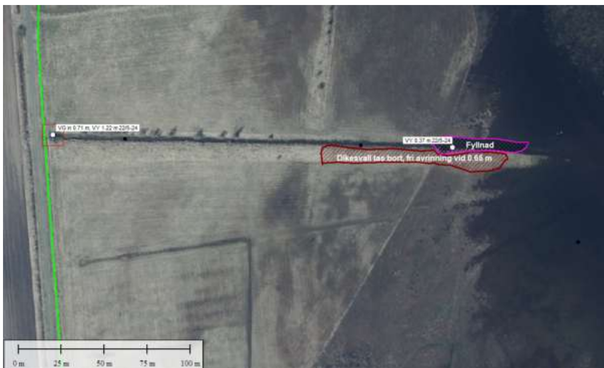
Figur 4: Vall och dike föreslås jämnas ut i nedströms (östra) delen. Arbetena måste göras mycket flackt men man kan ändå förvänta sig att vattnet stökar om lite efter åtgärd för att utjämna fallet på ca 30 cm mot våtmarksytan. Fyllnaden utförs så högt så lågpunkten (kring 0,6-0,65 m) styrs mot söder och begränsas av befintlig vegetationstäckt mark.
