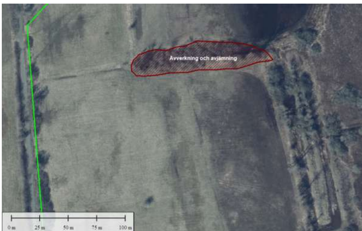
Figur 2: Trädraden tas bort och diket/rensvallen kan jämnas ut med schakt för enkel skötsel. Ytan som jämnas ut markeras med streckad bakgrund och reservatsgränsen med grön linje.
