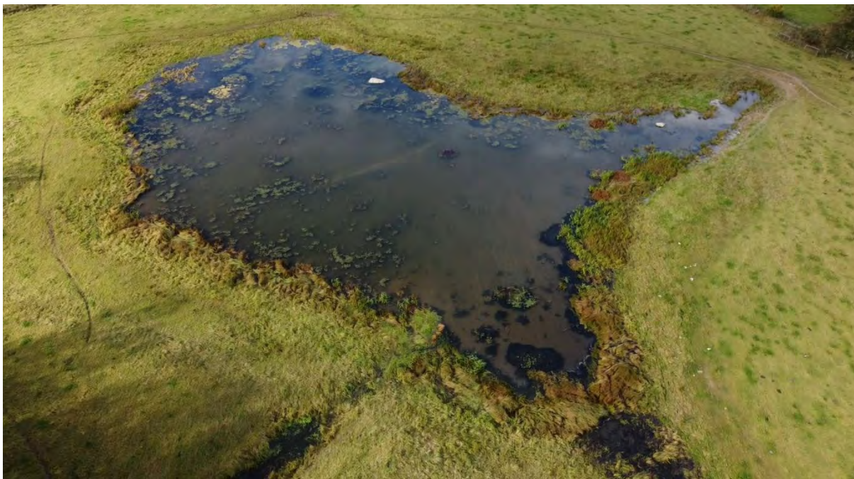
Bild 13. Våtmarken är inte optimalt konstruerad för att ge en lång uppehållstid. För optimal näringsretention bör in- och utlopp ligga på så långt avstånd ifrån varandra som möjligt. I bilden ligger inloppet uppe till höger och utloppet nere till höger. Foto: Mattis Vindelman.
