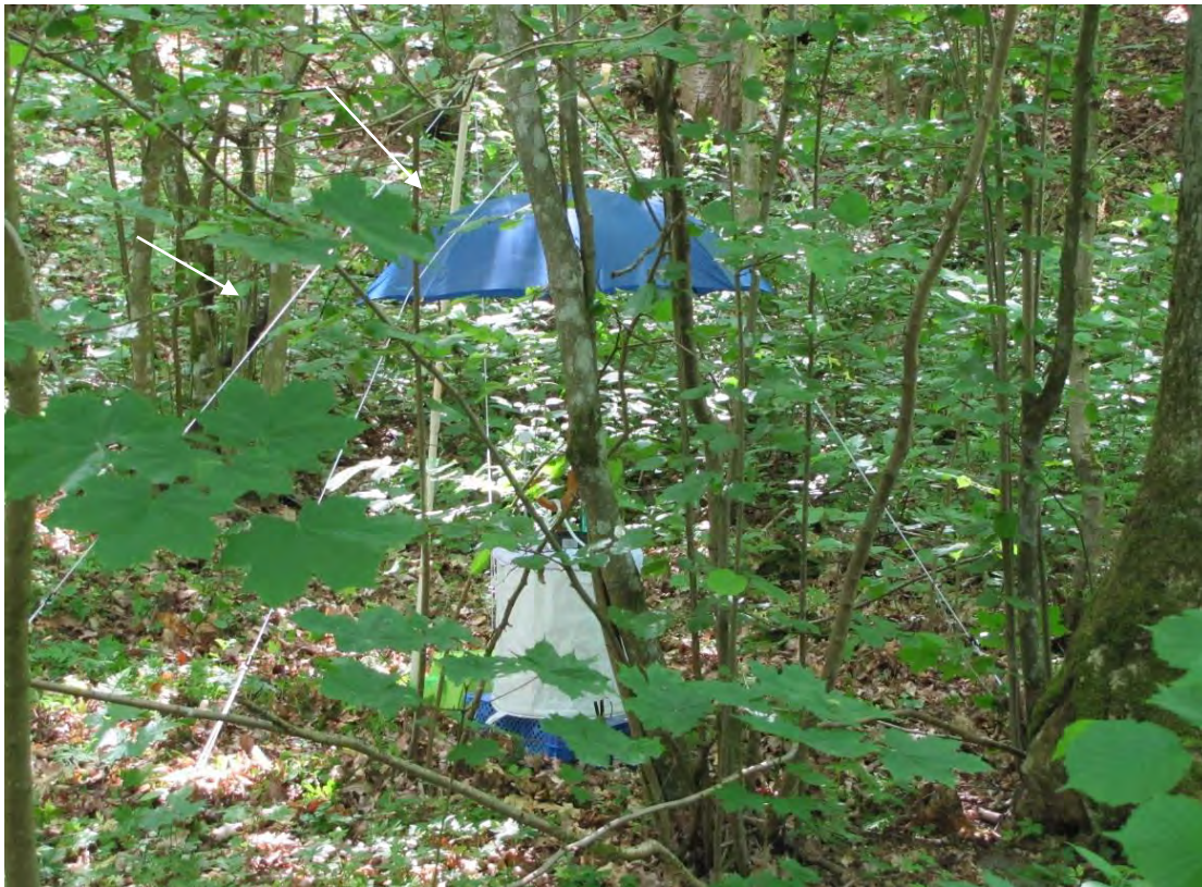
Figur 2. BG-fälla placerad i en buske. En stödbygelsliknande konstruktion av plast fasthåller med fyra rep BG fällan och det regnskyddande paraplyet.
