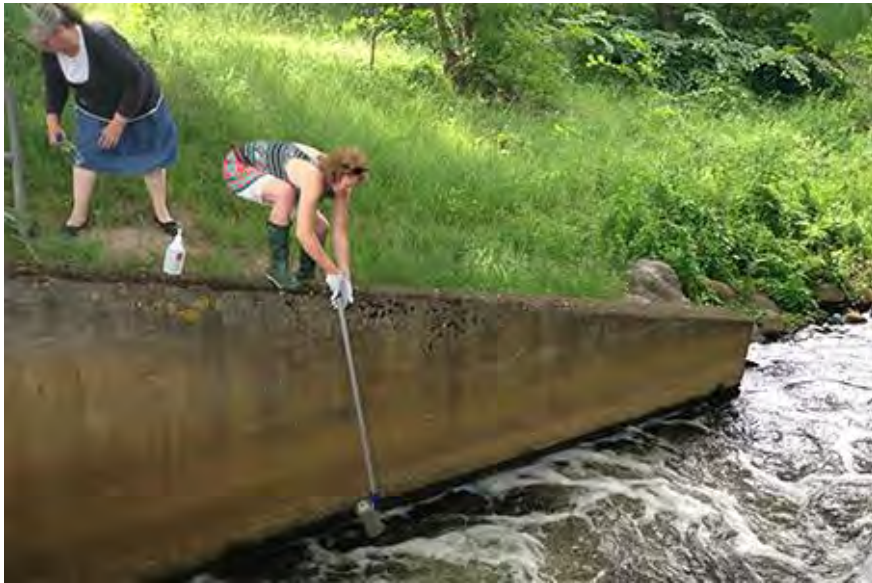
Figur 2. Provtagning vid Pyntens pumpstation där renat vatten från reningsverket pumpas ut i Hammarsjön.
