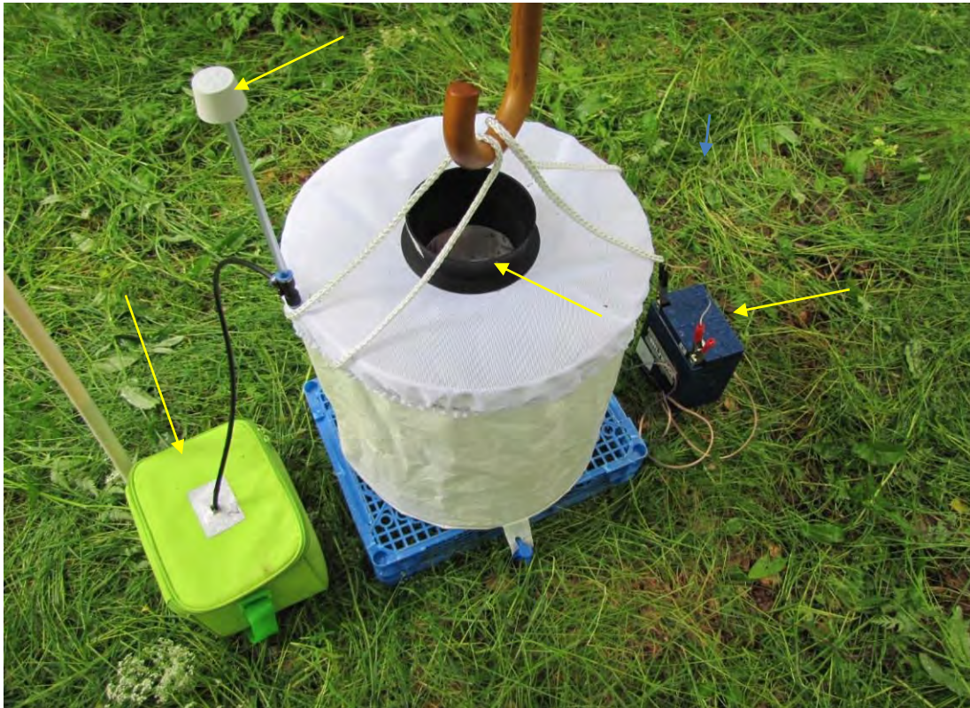
Figur 1. BG fälla för fångst av myggor. Pilarna visar ett 6V batteri, torris-boxen som matar koldioxid (CO 2 ) till spridaren (vit knapp) och den svarta fångsthuv. Ett paraply (handtaget är synligt) används för att förhindra regn från att komma in i fällan.
