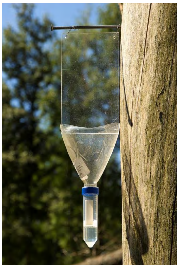
Fig. 2. Använd modell av fönsterfälla för enkel montering med en 7-tumsspik och tömning med lätt utbytbar Falcon-rör. Mellan den 12 x 24 mm stora plastskivan och röret tjänar en avklippt 2-liters PET-flaska som tratt. Denna fönsterfälla satt på en död, avbarkad tall i delområde 28.
